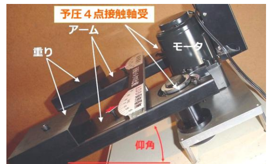
Fig 10 4点接触玉軸受の試験装置
